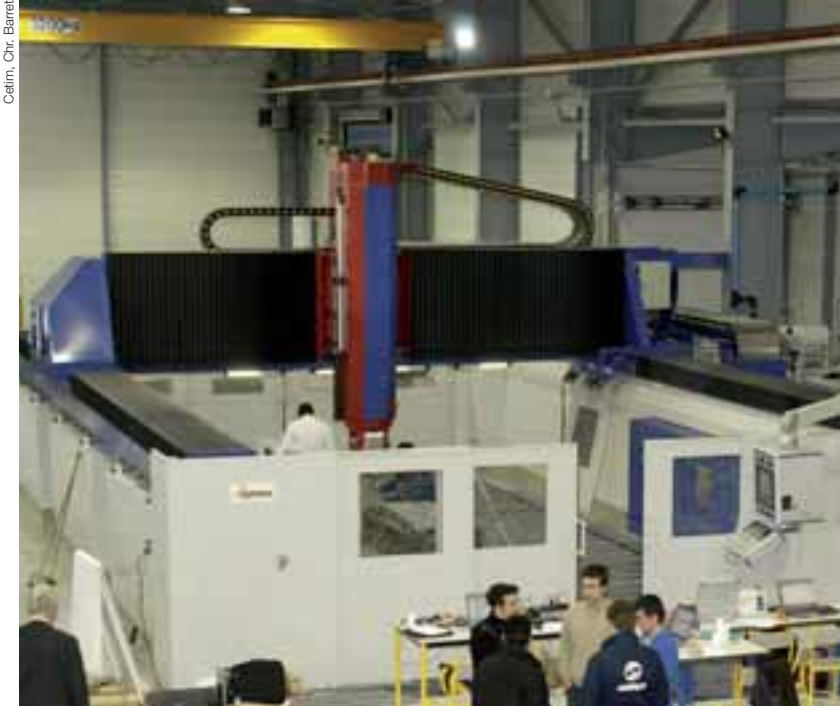
La nouvelle machine de finition des composites est basée sur une fraiseuse à portique, traverse haute, de Dufieux de façon à accepter des pièces de grande taille. La machine est équipée d'accéléromètres pour mesurer les vitesses de broche. Elle est pourvue d'une réserve de 13 outils.
