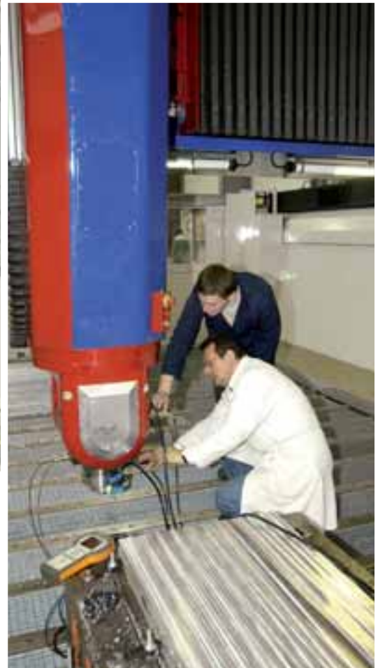
La nouvelle machine de finition des composites est basée sur une fraiseuse à portique, traverse haute, de Dufieux de façon à accepter des pièces de grande taille. La machine est équipée d'accéléromètres pour mesurer les vitesses de broche. Elle est pourvue d'une réserve de 13 outils.
